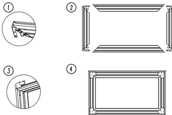
注: 如是拼接框或带支撑杆大尺寸, 先用直码将四条上下框拼接起来, 然后按上图2.3步骤连接好后, 将支撑杆固定在上下边框, 装好后如图所示。
